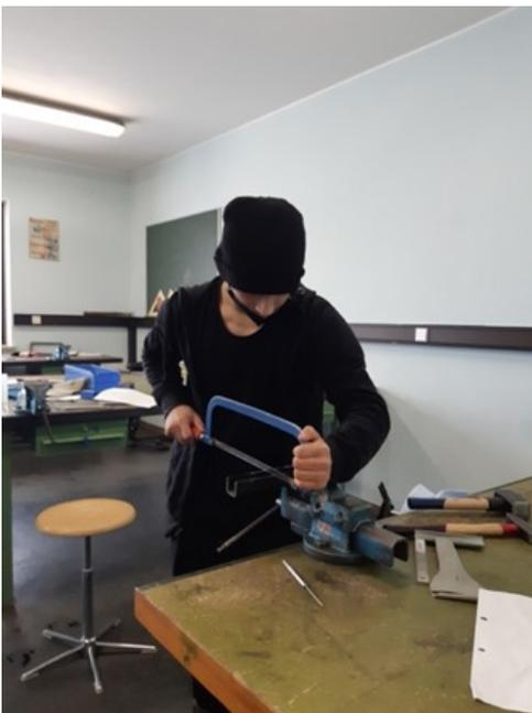
Im ersten Jahrgang Gartenbau wird im praktischen Unterricht in **Maschinen und Anlagen** der Umgang mit Handwerkzeugen und einfachen Maschinen geübt. Dazu wird an Hand eines Werkplanes ein Metallwerkstück (ein Teil eines Mähbalkens) durch Bearbeitung mit Hilfe von Feilen, Sägen, Bohren und Messen hergestellt. Für viele Schüler\*innen ist es das erste Mal mit dem Material Metall zu arbeiten und genaue Fertigkeiten mithilfe von Metallwerkzeugen zu erlangen.
